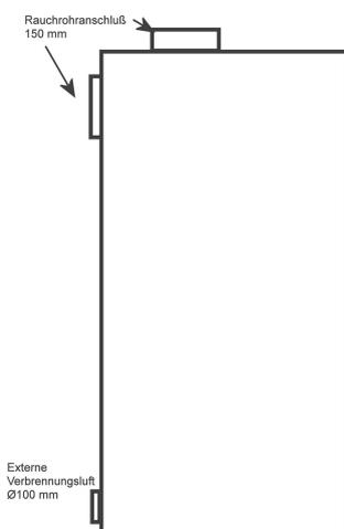
Die in dieser Anleitung beschriebenen Kaminöfen der Bauart 1 sind nach DIN EN 13240 geprüft. Kaminöfen dieser Bauart dürfen an mehrfach belegte Schornsteine angeschlossen werden, sofern die Dimension des Schornsteins dieses zulässt. Die DIN 4705, Teil 3 ist zu beachten.
